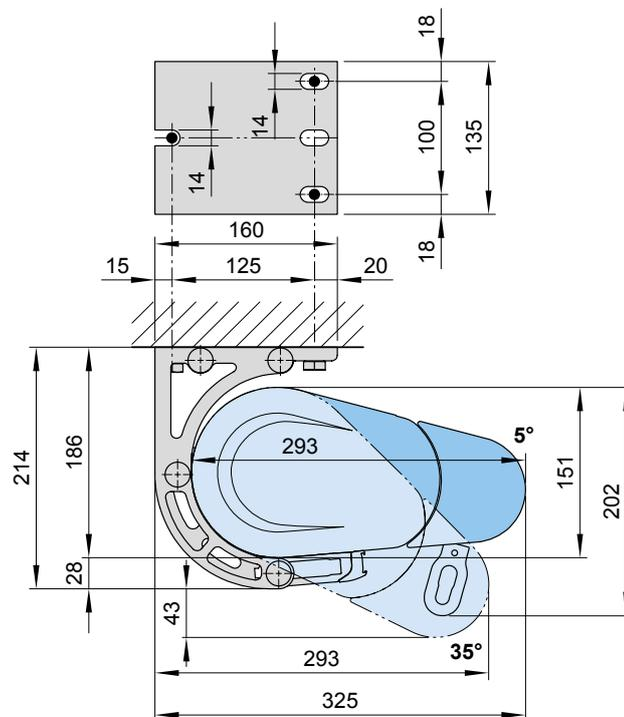
76385. = Wandanschlussprofil (Standardbreite = Markisenbreite (M); bis max. 65° Markisenneigung)
