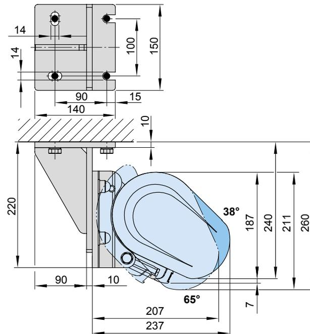
**76385.** = Wandanschlussprofil (Standardbreite = Markisenbreite (**M**); bis max. 65° Markisenneigung)
