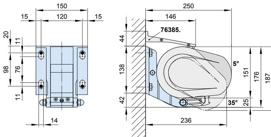
**76385.** = Wandanschlussprofil (Standardbreite = Markisenbreite (M); bis max. 65° Markisenneigung)
